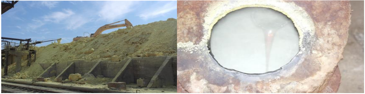
13-расм. а) Олтингугурт омбори; б) Олтингугуртнинг суяқ ҳолатда кувурда оқиши тасвирланган.
