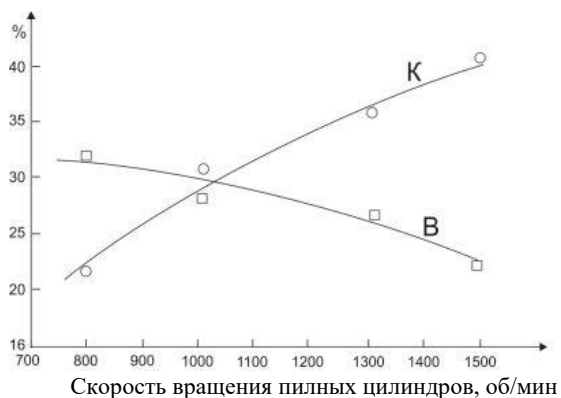
Рисунок 10. Зависимость очистительного эффекта (К) и волокнистости (В) отходов от скорости вращения пильных цилиндров разработанного двухсекционного волокноочистителя.
