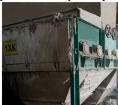
10-расм. Таъминлагичи учинчи ва тўртинчи барабанлар оралиғига ўзгартирилган пахтани ифлосликлардан тозалагичининг умумий кўриниши
