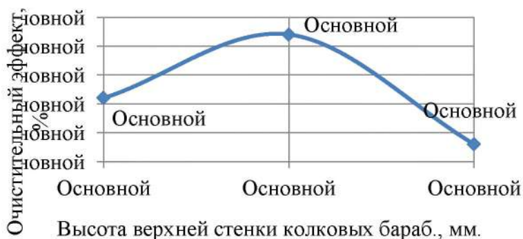
Рис.9. Эффективность очистки при переработке II ром сорта 2 класса (при установке пружинного направителя) в зависимости от высоты верхней стенки колкового барабана
