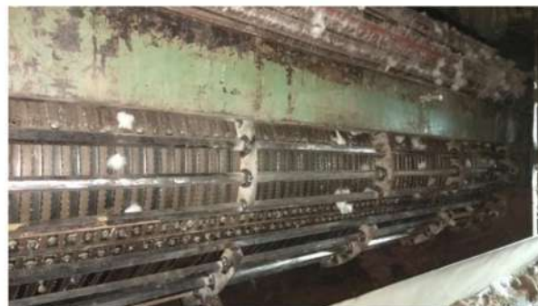
11-расм. Пахтани йирик ифлосликлардан тозалаш учун мўлжалланган УХК русумли машинага ўрнатилган тавсия қилинган олти қиррали конуссимон колосниклар
