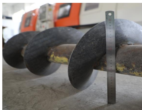
11-расм. Ёниш камерасига ўрнатиладиган винтли йўналтиргичнинг схемаси ва умумий кўриниши
