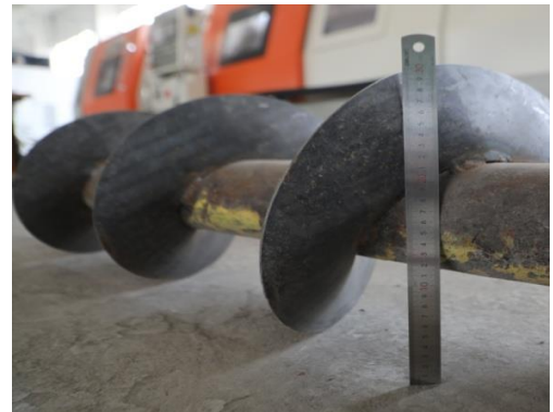
9-рисунок Схема и общий вид винтового направителя для установки в камере сгорания
