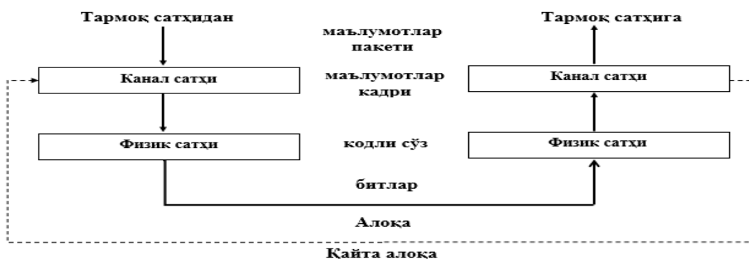
4-расм. Симли тармоқнинг маълумот узатиш звеносининг функционал архитектураси
