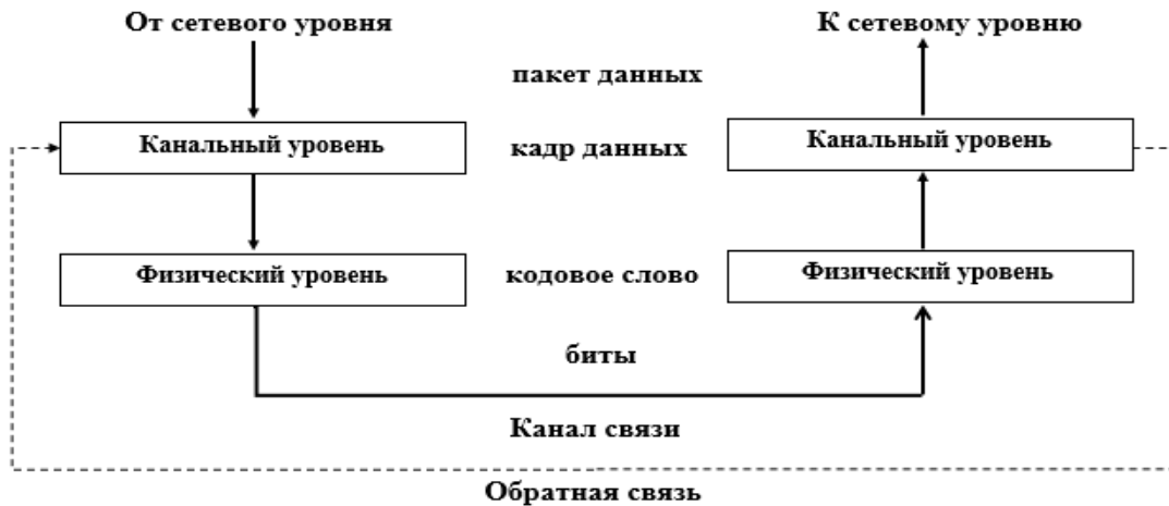
Рис.4. Функциональная архитектура звена передачи проводных сетей
