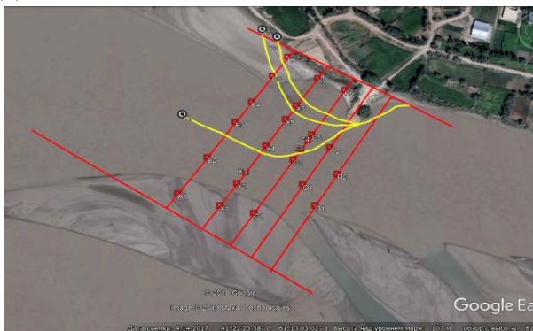
Рис.4. Схема расположения створов и вертикалей на исследуемом участке дамбы №30 (река Амударья)
