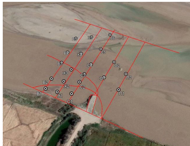
5-расм. №19 дамба тадқиқотлари бажарилган участкада створ ва вертикалларнинг жойланиш схемаси(Амударё)
