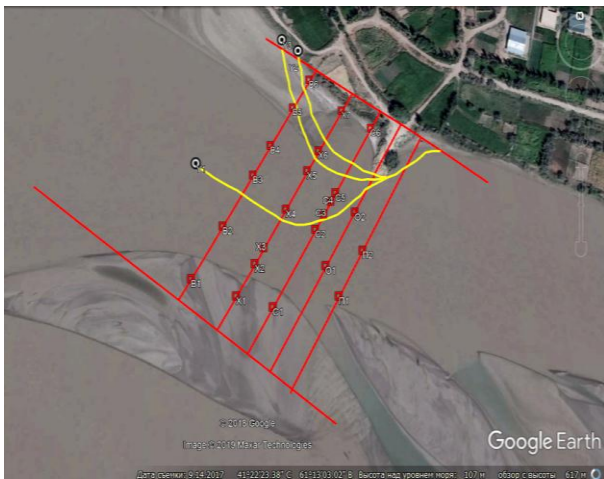
4-расм. №30 дамба тадқиқотлари бажарилган участкада створ ва вертикалларнинг жойланиш схемаси(Амударё)
