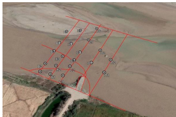
Рис.5. Схема расположения створов и вертикалей на исследуемом участке дамбы №19 (река Амударья)
