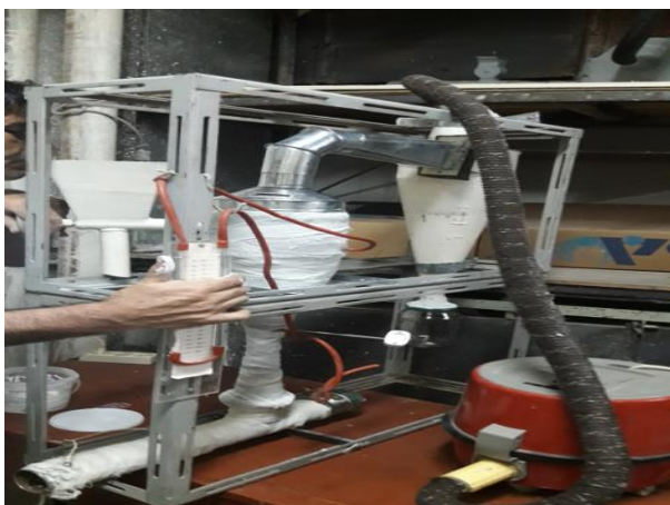
7-расм. Кимёвий усулда олинган бўрни қуриштиш учун тажриба ускунаси расми.
