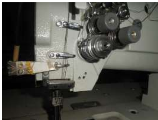
б – ипни таранглигини созлаш 9-расм. тензобалкани қўллаб игна ипининг таранглагини ўзгариш қонуниятини аниқлаш бўйича ускуна кўринишлари.
