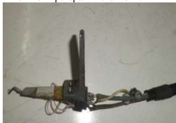
б – ипни таранглигини созлаш 9-расм. тензобалкани қўллаб игна ипининг таранглагини ўзгариш қонуниятини аниқлаш бўйича ускуна кўринишлари.
