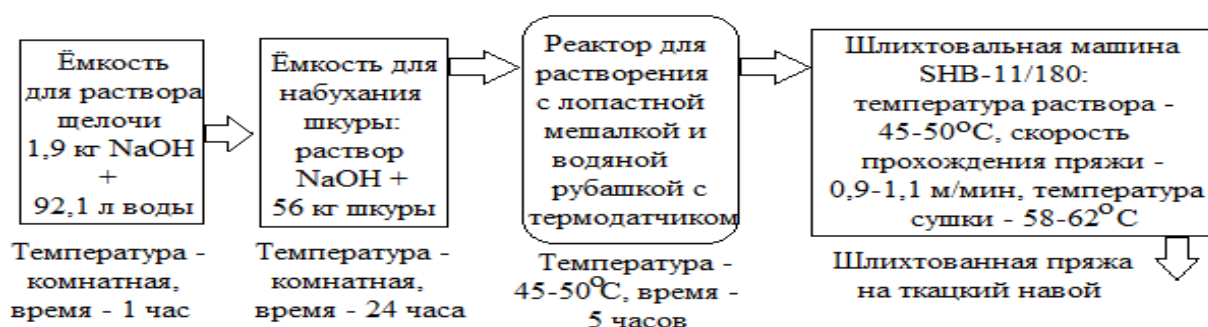
Рис. 14. Технология шлихтования хлопковой пряжи коллагеновой композицией.
