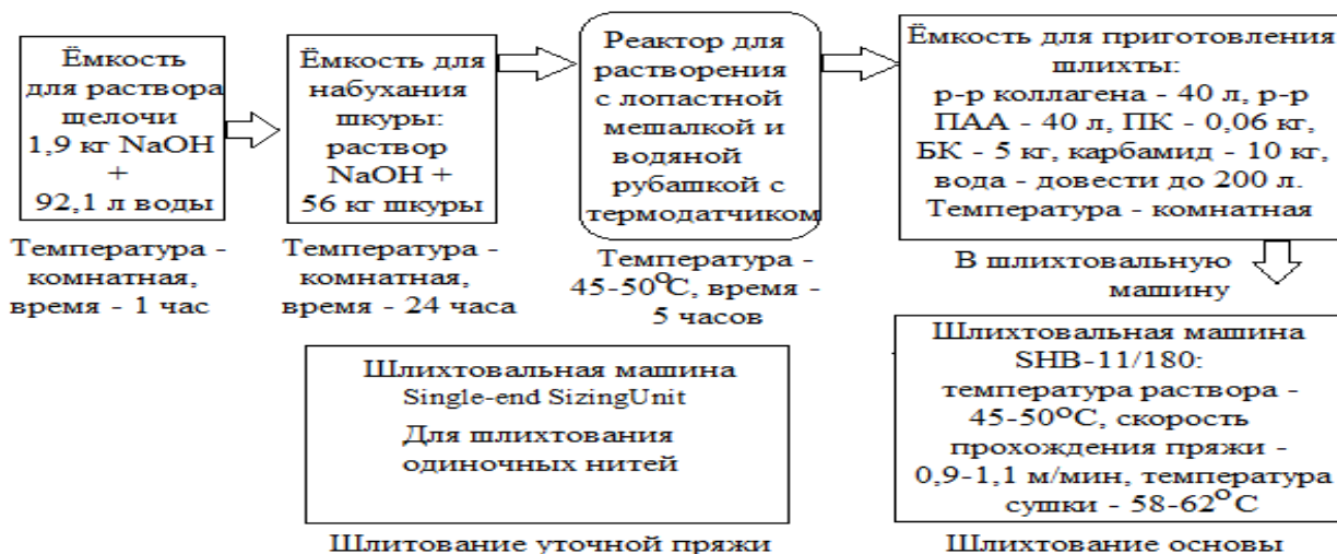
Рис. 15. Совмещенная технология шлихтования и огнезащитной обработки хлопковой пряжи коллагеновой огнезащитной композицией.
