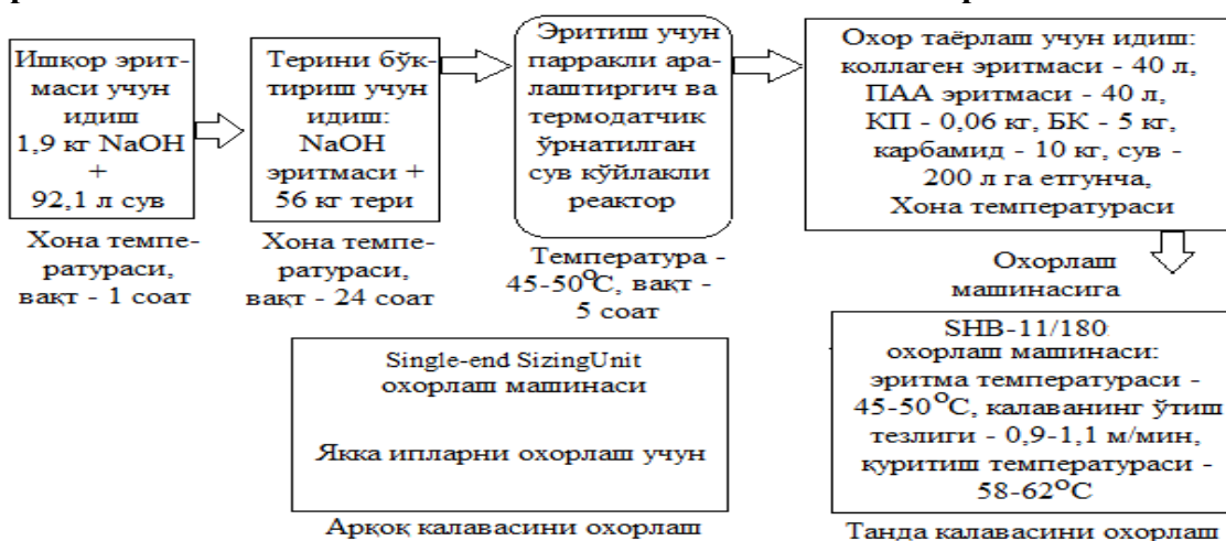
15-расм. Коллаген композицияси билан пахта калавасини охорлаш ва оловбардош ишлов беришнинг бирлашган технологияси.
