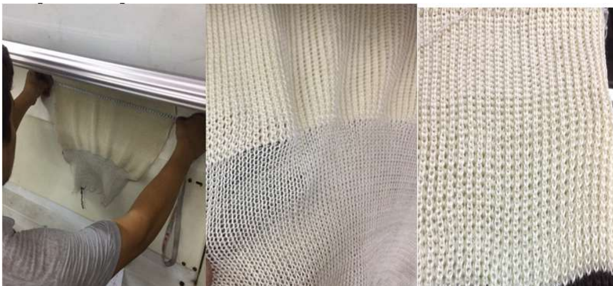
15-расм. Зоналар бўйича турли хил чўзилувчанликка эга поликомпонентли трикотажнинг хусусиятлари аввалдан башорат қилинган кийим деталларини тўқиш жараёни
