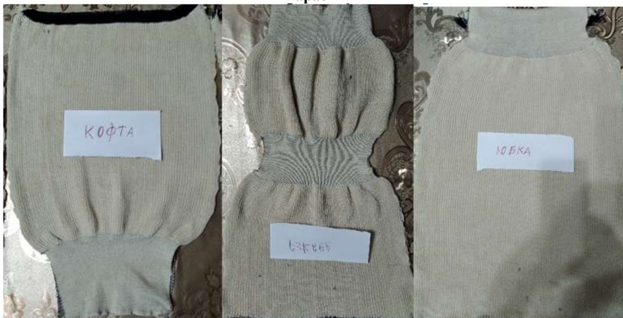
16-расм. Ярим мунтазам усулда ишлаб чиқилган поликомпонентли устки трикотаж тўпламининг алоҳида деталлари
