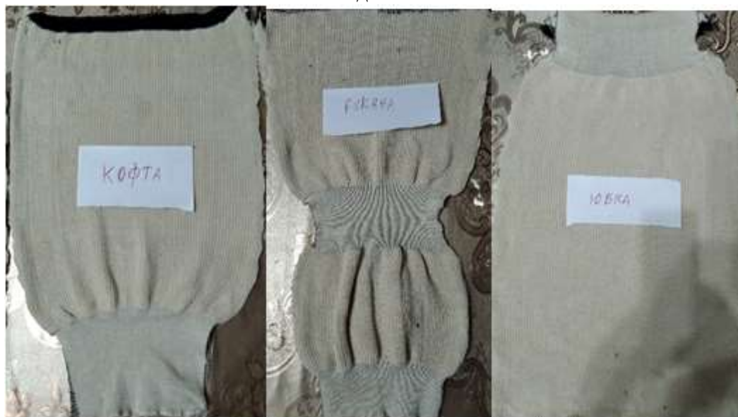
Рис.14. Выработанные отдельные детали верхнего поликомпонентного трикотажного комплекта, выработанного полурегулярным способом
