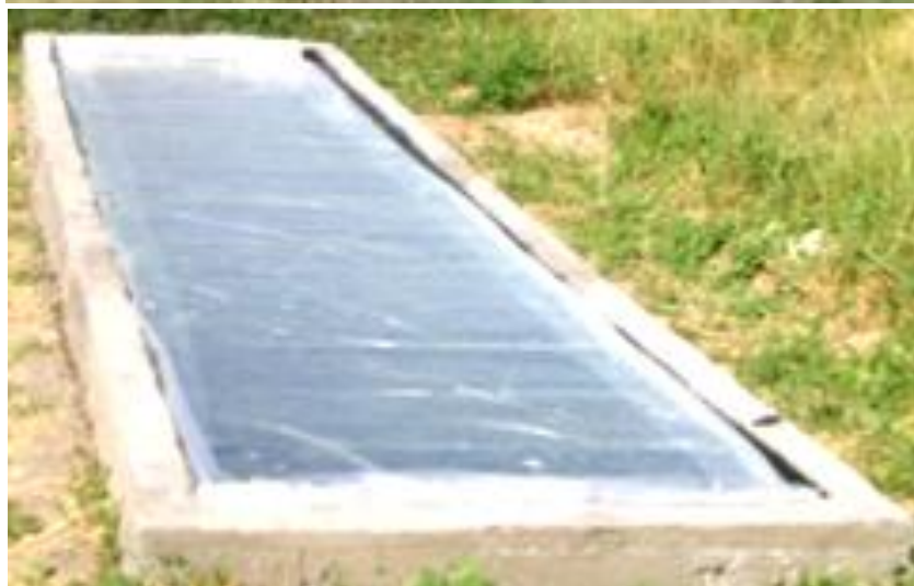
a - ПСВК с 0,84 \text{ м}^2 , б - ПСВК с 5 \text{ м}^2 без СП, в -ПСВК с 5 \text{ м}^2 с СП. Рис.11. Общий вид емкостного солнечного коллектора, изготовленного из местных строительных материалов.
