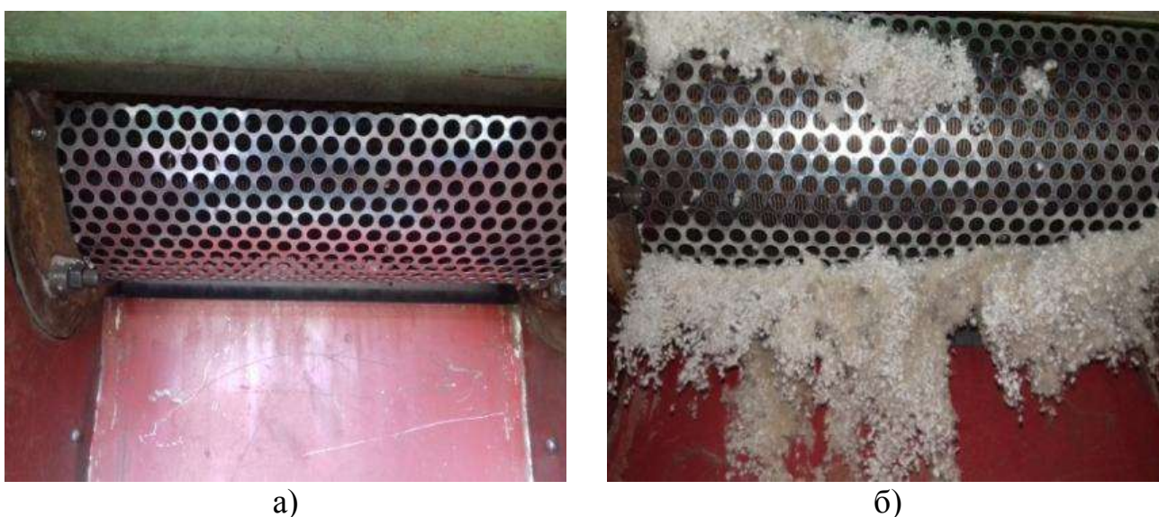
Рис.7. Монтаж изготовленной перфорированной рабочей поверхности (а) и процесс обработки (б)
