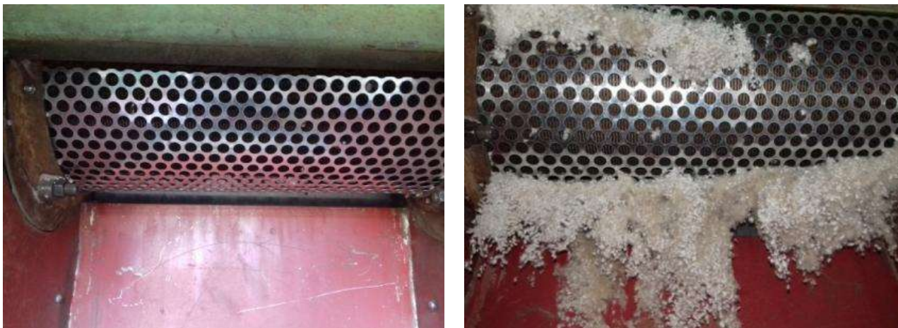
7–расм. Тайёрланган перфорацияли ишчи сиртни ўрнатилиши (а) ва ишлаш жараёни (б)
