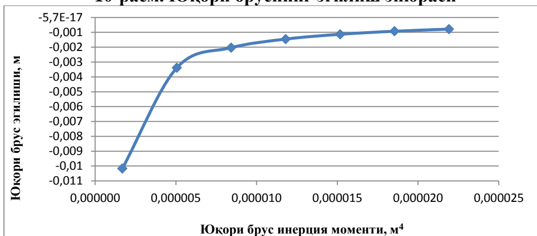
11-расм. Юқори брус инерция моментига боғлиқ ҳолда юқори брус эгилишининг ўзгариши
