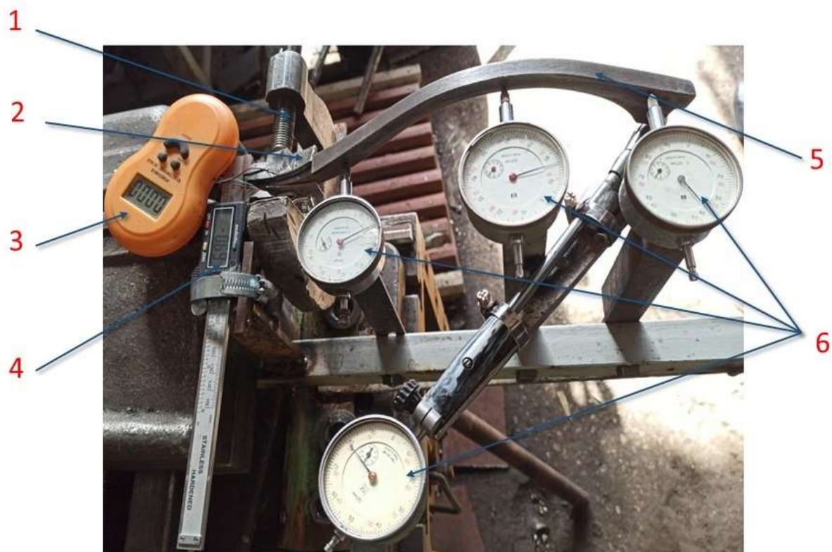
1 – сила зажима; 2 – вставка; 3 – устройство измерения нагрузки; 4 – штангенциркуль; 5 – консоль колосник; 6 – индикаторы часового типа марки ИЧ-10 0.01
