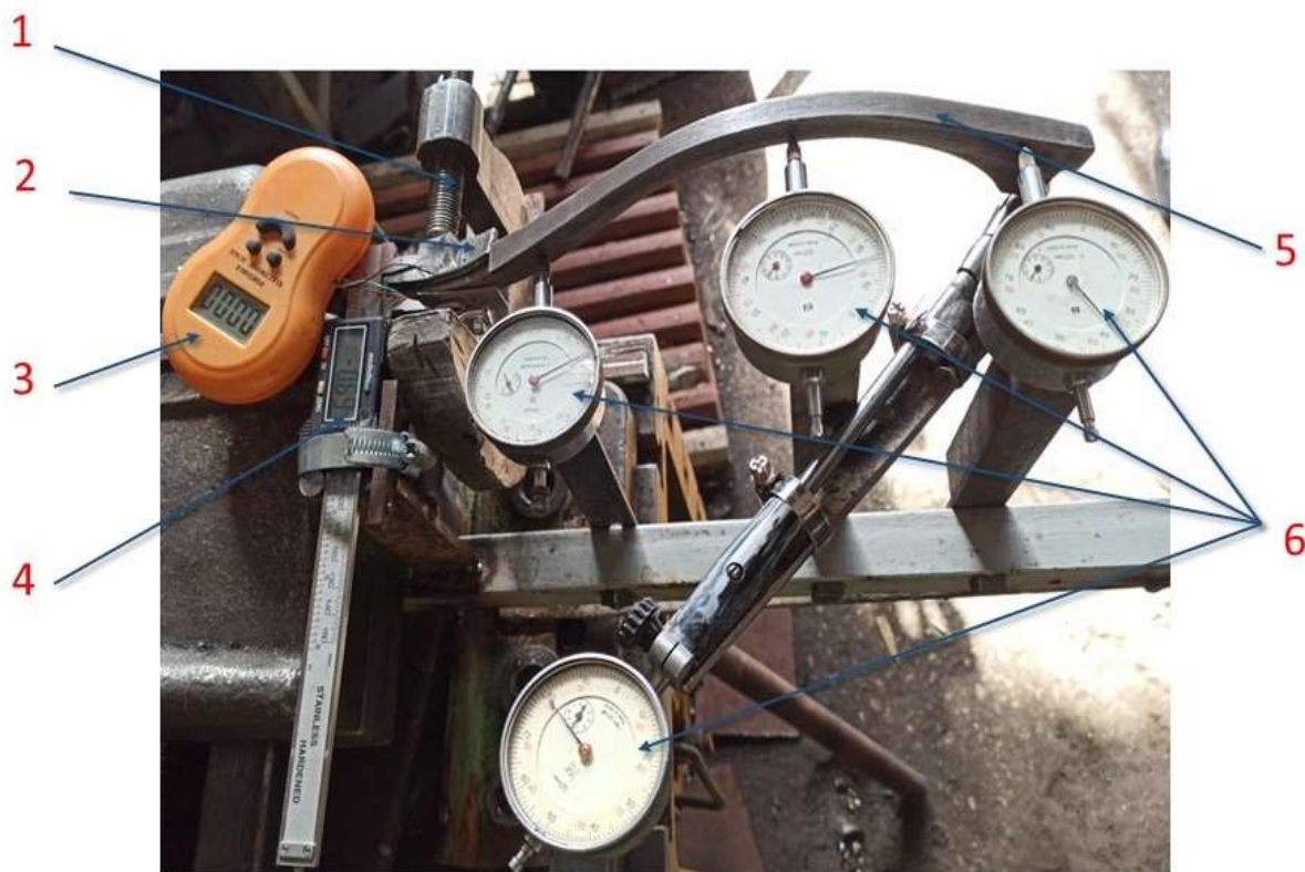
1 – сиқувчи куч; 2 – алмашинувчи элемент; 3 – юк ўлчовчи қурилма; 4 – штангенциркуль; 5 – консоль колосник; 6 – ИЧ-10 0.01 маркали соат типидagi индикаторлар
