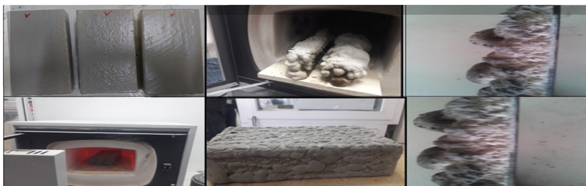
Рис.5. Процесс термического воздействия на металлические и деревянные образцы
