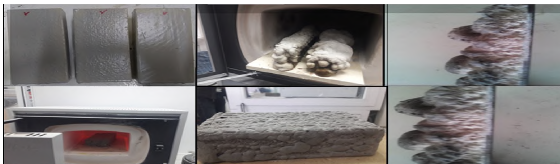
5-расм. Металл ва ёғоч намуналарига термик таъсир бериш жараёни тасвирланган.
