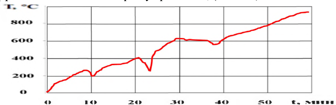
Рис. 6. Процесс термического воздействия 780°С на образец древесины, обработанный новым составом на основе огнеупорного покрытия
