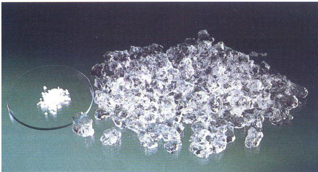
Рис. 1. Состояние, пропитанного водой гидрогеля
