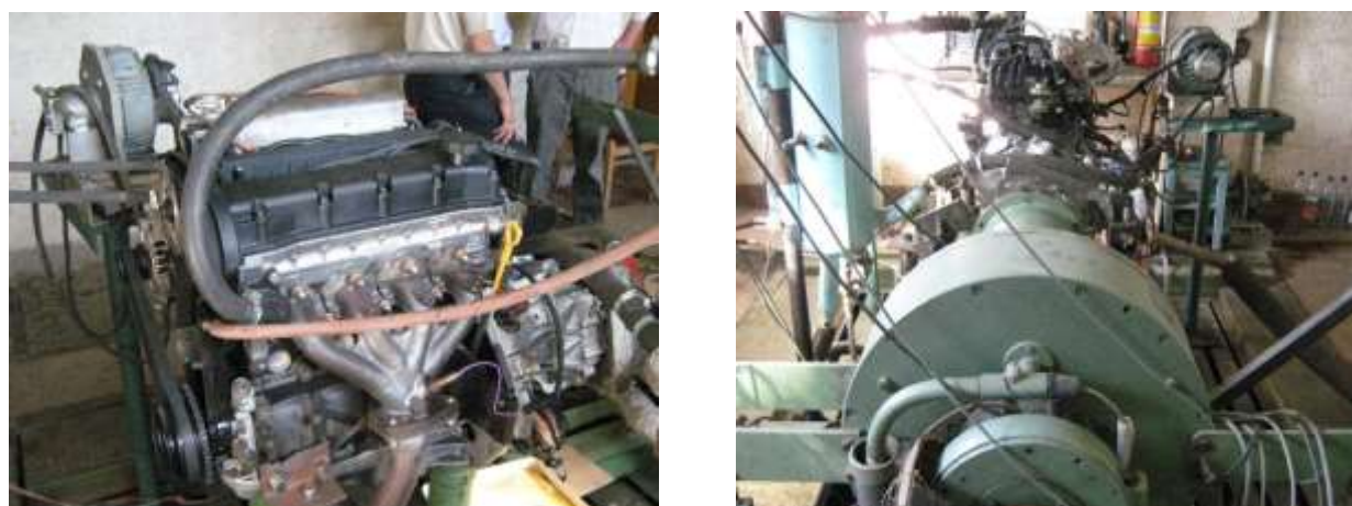
Рис. 3.3. Проведение стендовых исследований на индукторном тормозном стенде «SchenkWS-230»
