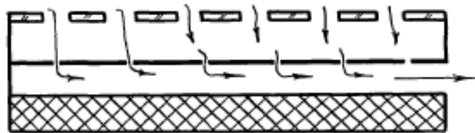
5-расм. Тешик юзали иссиқлик қабул қилувчи қуёшли ҳавоқиздиргич.
