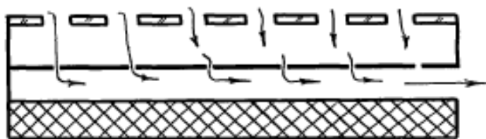
Рис.5. Солнечный воздухонагреватель с отверстием для приема тепла.
