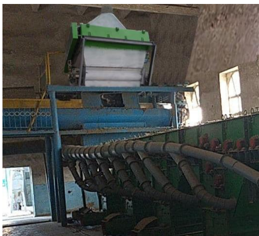
11-расм. Ишлаб чиқарилган сепаратор-тозалагичнинг умумий кўриниши ва уни заводдаги СС-15А пахта сепаратори ўрнига ўрнатилган кўриниши.
