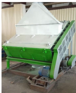
Рисунок 11. Фотографии изготовленного сепаратора-очистителя и его установки в место сепаратора хлопка СС-15А на заводе.
