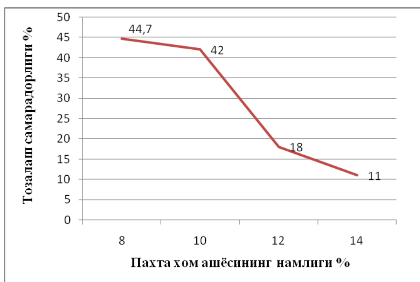
7-расм. сепаратор-тозалагичнинг тозалаш эффеќтининг пахта намлигига боғлиқлик графиги
