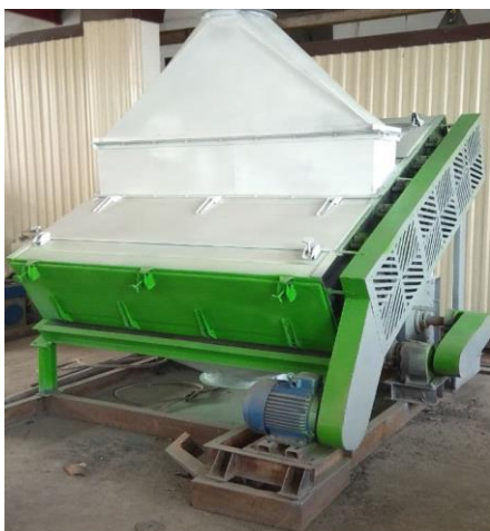
11-расм. Ишлаб чиқарилган сепаратор-тозалагичнинг умумий кўриниши ва уни заводдаги СС-15А пахта сепаратори ўрнига ўрнатилган кўриниши.
