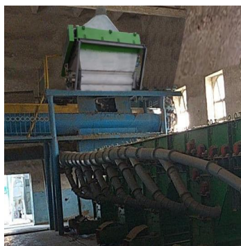
Рисунок 11. Фотографии изготовленного сепаратора-очистителя и его установки в место сепаратора хлопка СС-15А на заводе.
