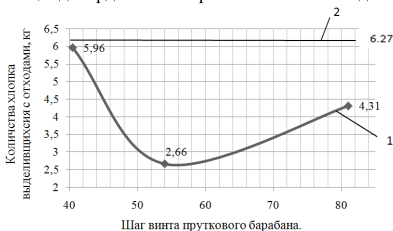
1- тажриба пахта регенератори, 2- амалдаги регенератор. 12-расм. Қозикли барабан винти қадамининг чиқинди билан бирга ажраладиган пахта миқдorigа боғлиқлик графиги.
