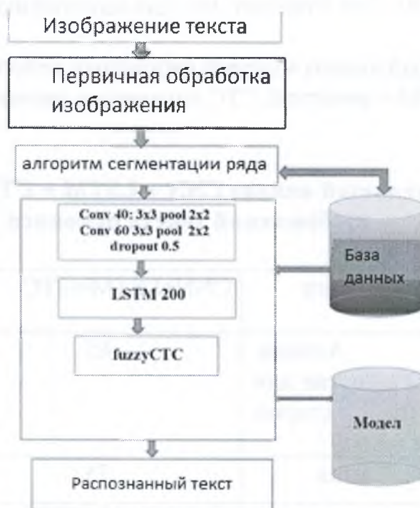
Рис 1. Функциональная схема гибридного алгоритма распознавания изображений текста рукописи
