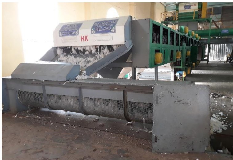
Рис.15.Общий вид модернизированного очистителя, установленного Сайхунабадском хлопкоочистительном заводе
