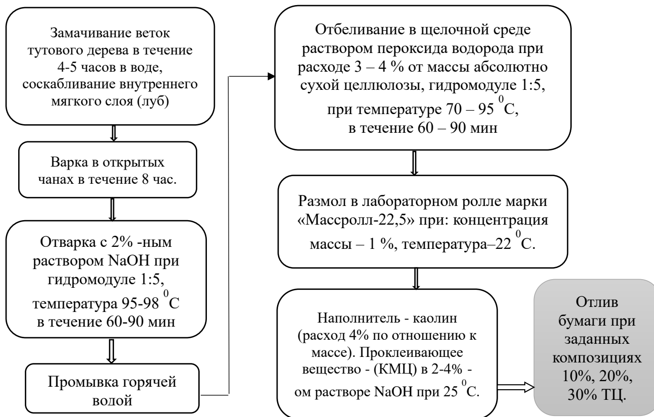
Рис.3. Общая технологическая схема изготовления бумаги
