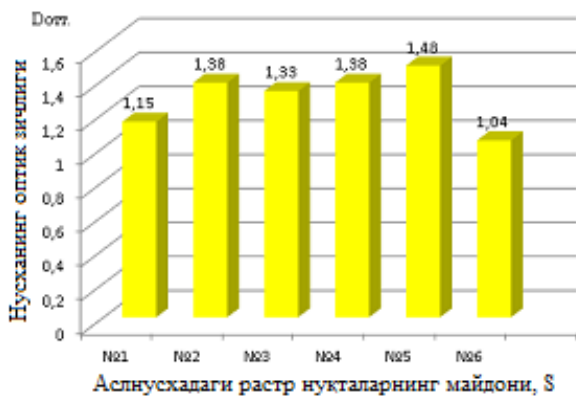
а – ҳаворанг, б – қирмизи, в – сариқ ва г – қора бўёқ 12-расм. Тажрибавий қоғозларда пуркашли босмада нусха плашкаларининг оптик зичликлари
