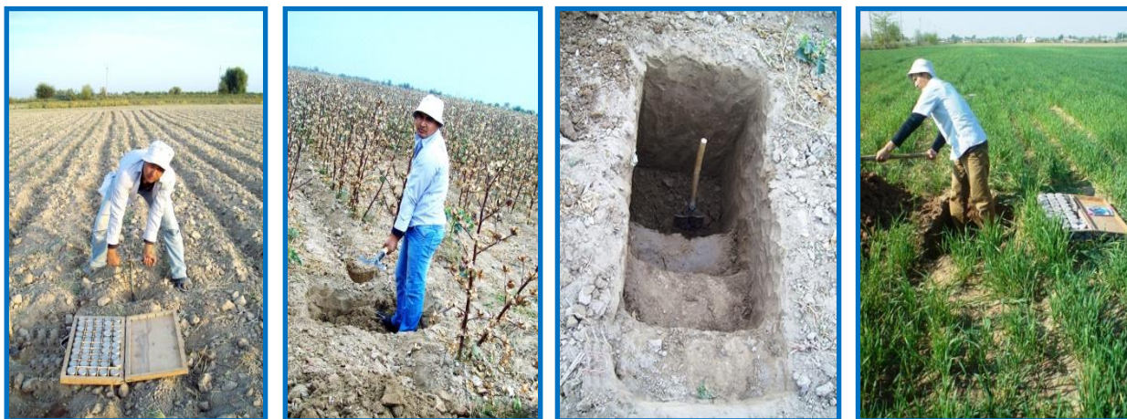
7-расм. Тупроқнинг ҳажм оғирлиги, ғоваклиги ва намлигини аниқлаш
