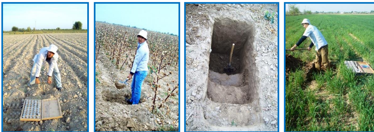
Рисунок 7. Определение объемного веса, пористости и влажности почвы
