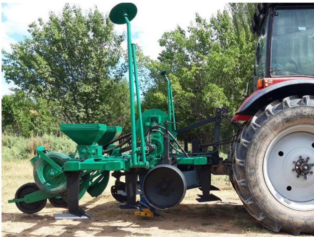
**4-расм. Комбинациялашган агрегатнинг умумий кўриниши**
