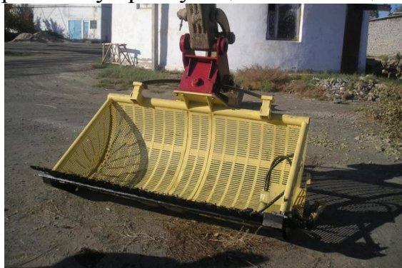
Рис. 3. Ковш-косилка марки КК-2,1 навешанный на гидравлический экскаватор
