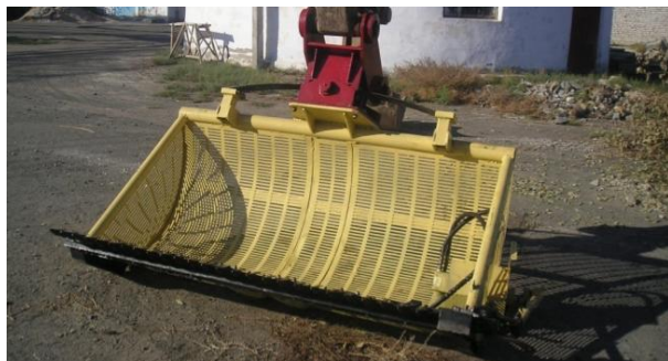
3-расм. Экскаваторга ўрнатилган КК-2,1 маркали ковш-ўргич
