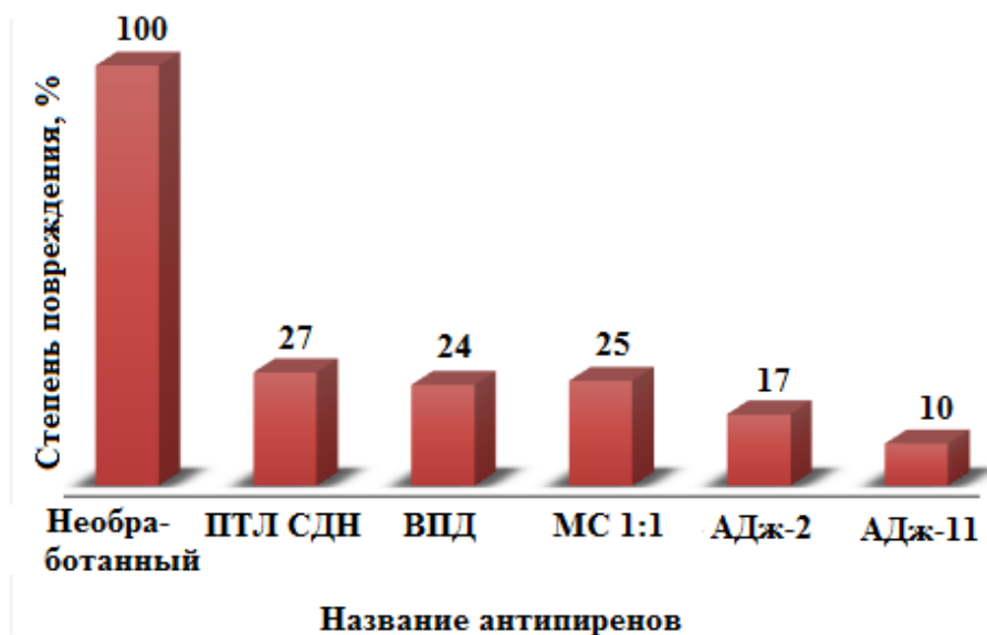
Рисунок-3. Степень повреждения по длине образцов древесины, обработанных веществами с огнезащитными свойствами
