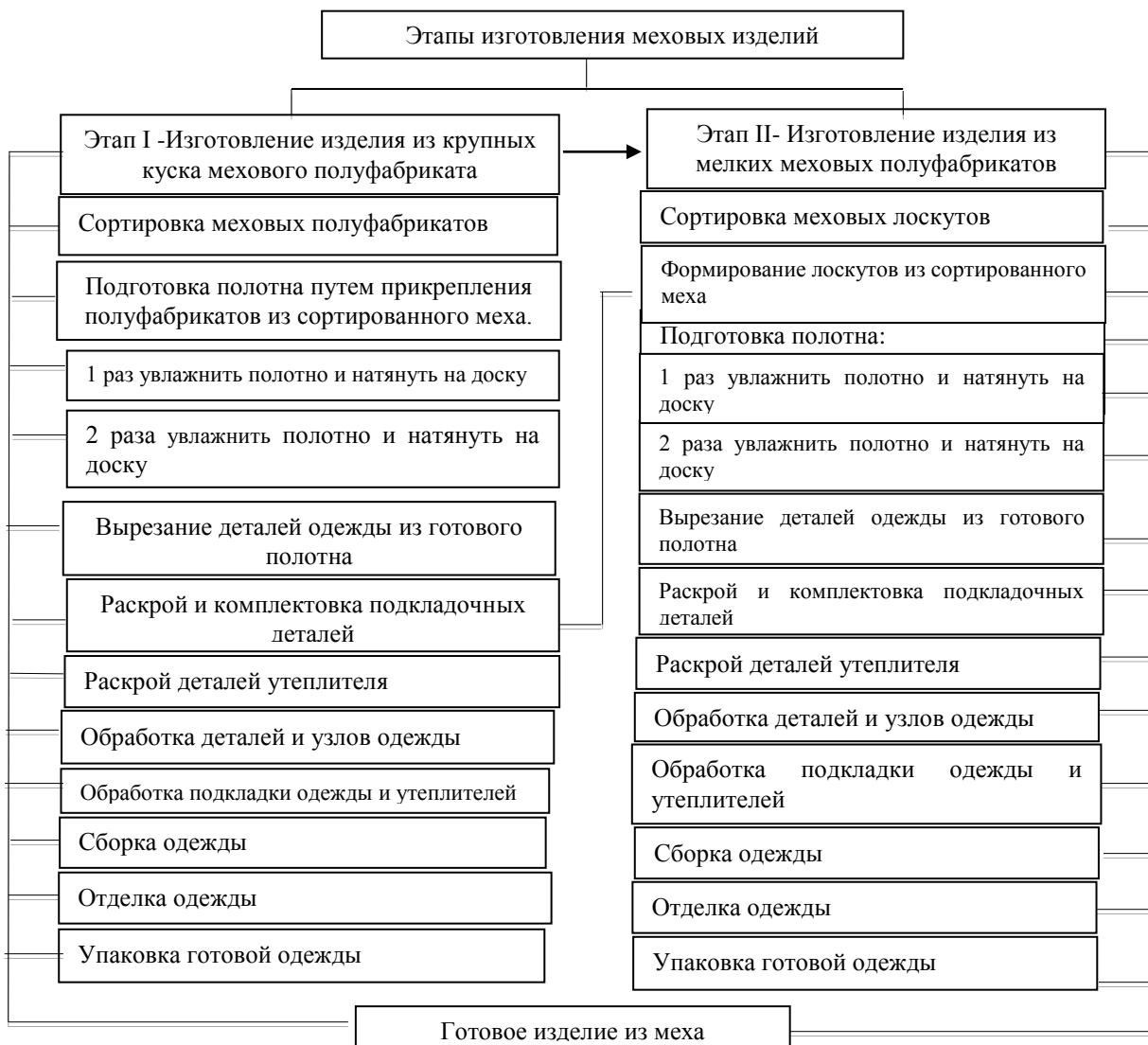
Рис. 11. Двухэтапная технологическая схема изготовления верхней женской одежды из натурального меха
