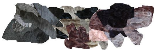
6-расм. Мўйнадўзликда бичиш вақтида ҳосил бўлган ишлаб чиқариш чиқиндилари.
