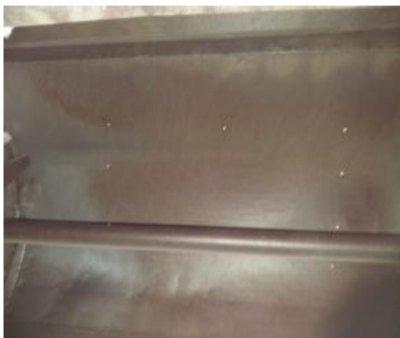
12-Рasm. Ишчи камера орқа деворининг шикастланиш кўриниши.
