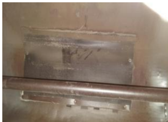
13-Рasm. Ишчи камера орқа деворига ўрнатилган амортизаторли пластина қурилмасининг кўриниши.
