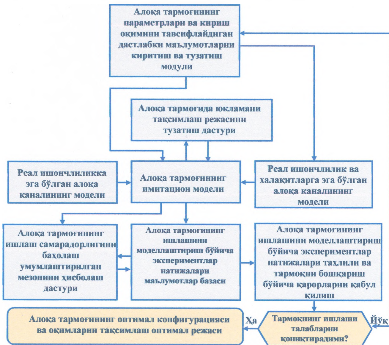
4-расм Алоқа тармоғининг ишлашини ва бошқарувини баҳолаш дастурлари мажмуасининг блок-схемаси
