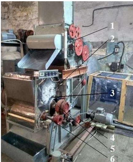
1 – двух барабанный питатель; 2 - рабочая камера; 3 - колосник; 4 – щёточный барабан; 5 - пильный цилиндр; 6 - набрасывающий барабан
