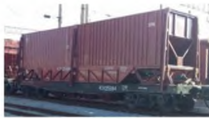
Рис. 19. Вагон-зерновоз, разработанный на базе УП «Узтемирйулмаштаъмир»
