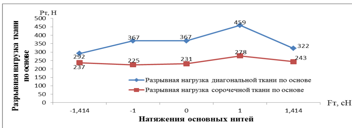
Рис. 5. Действия натяжения основных нитей на разрывной нагрузке ткани по основе.
