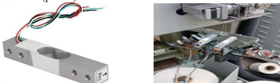
Рис. 7 Устройство контроля натяжения пряжи с установленными тензо- датчиками.
