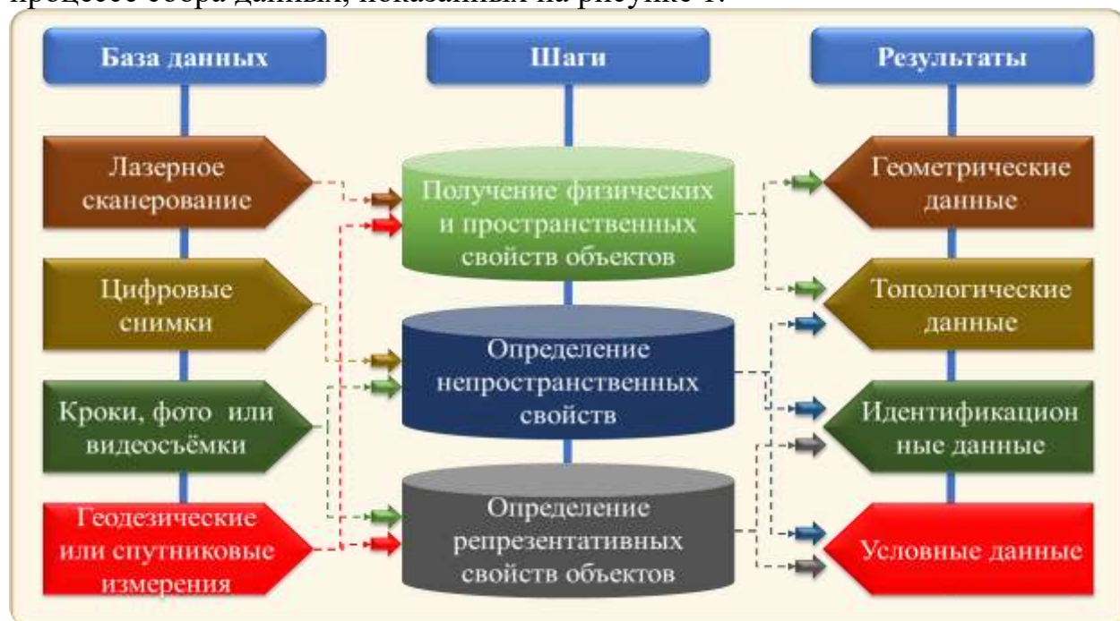
Рис. 1. Функциональная схема сбора данных в технологии лазерного сканирования
