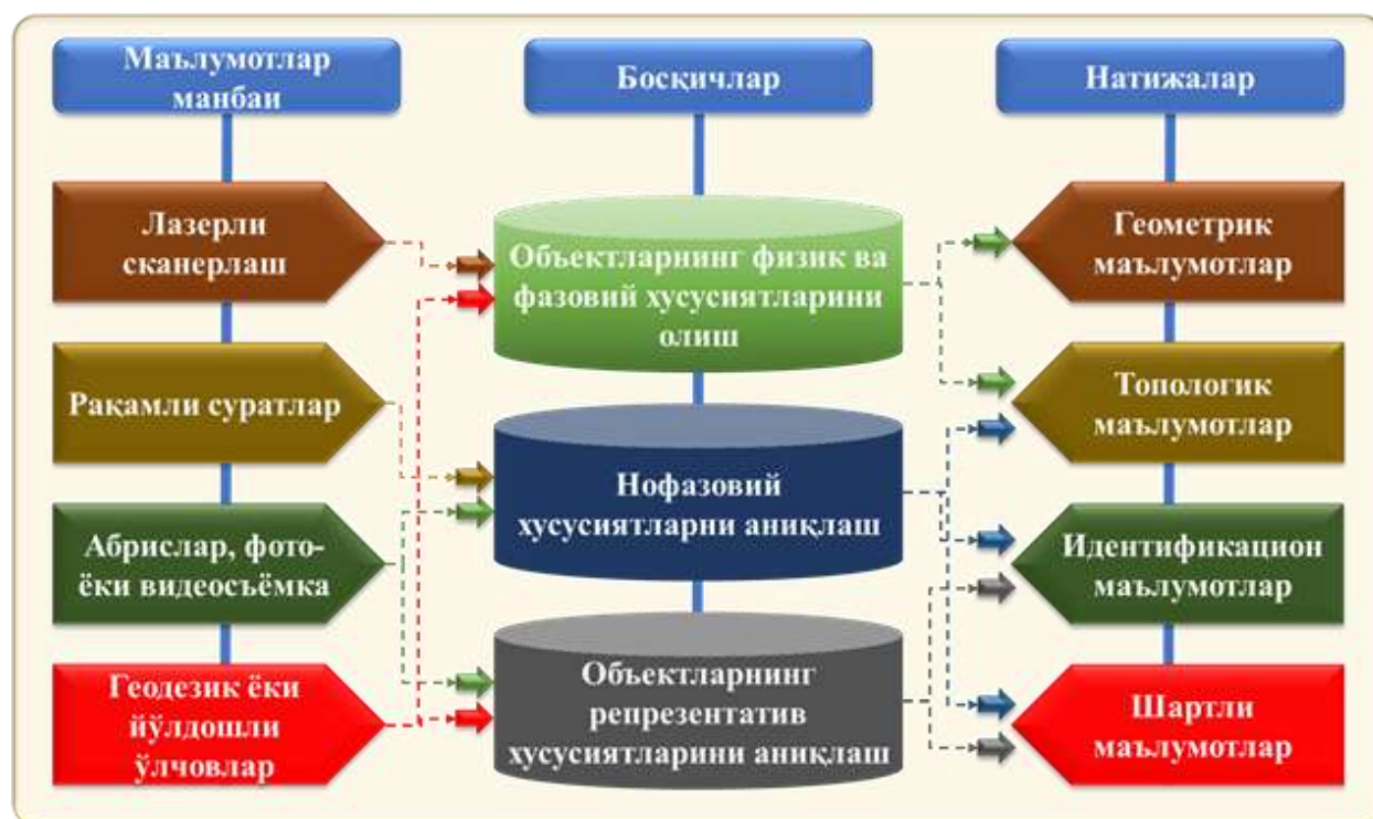
1-расм. Лазерли сканерлаш технологиясида маълумотлар олишнинг функционал схемаси
