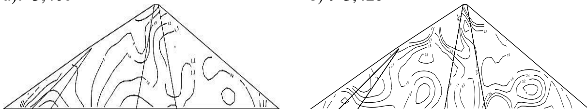
Рис.11. Изолинии распределения коэффициента запаса прочности ( K ) в зависимости от продолжительности времени t=3,40с (а) и t=3,42с (б) грунтовой плотины при упругом деформировании грунта
