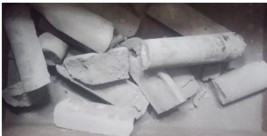
Рис. 4. Снимок карбидизированных образцов при температуре 2200 °С в течение 6 часов
