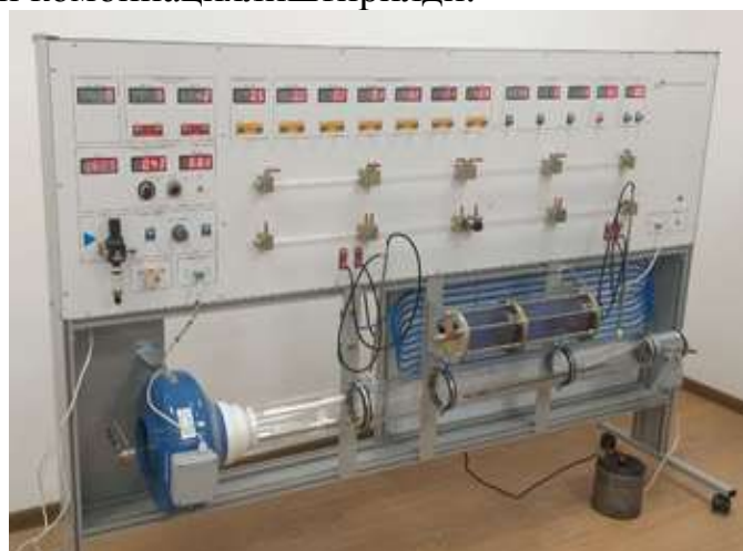
1-рasm. Ютилиш ва нурланиш билан кечадиган жараёнларни НТЦ-22.05.21 стeнди базасида ўрганиш учун схема ва қурилма
