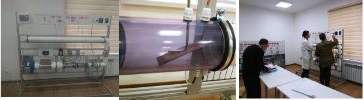
Рис. 4. Исследование определения зависимости коэффициента конвективного теплообмена от типа потока и скорости газов
