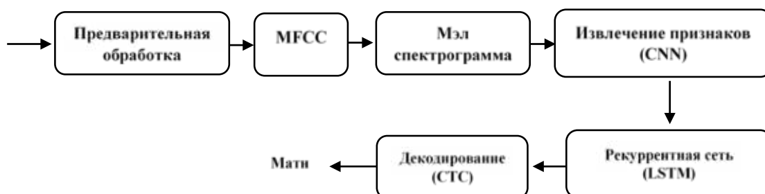
Рис.7. Шаги распознавания речи на основе интегрированных нейронных сетей
