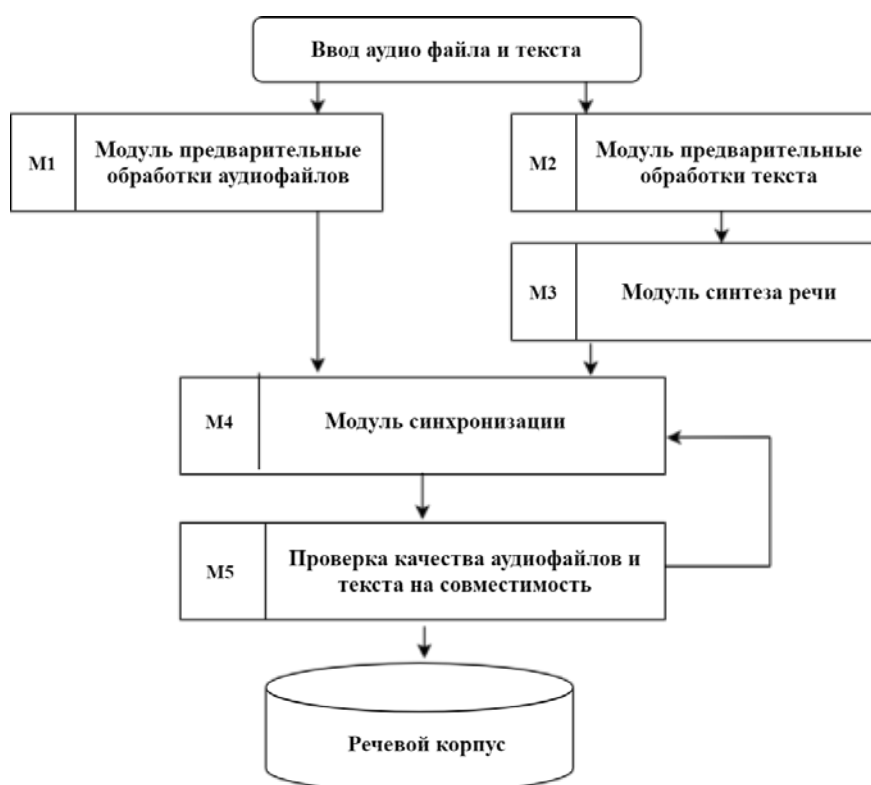
Рис. 11. Схема работы программы формирования речевого корпуса
