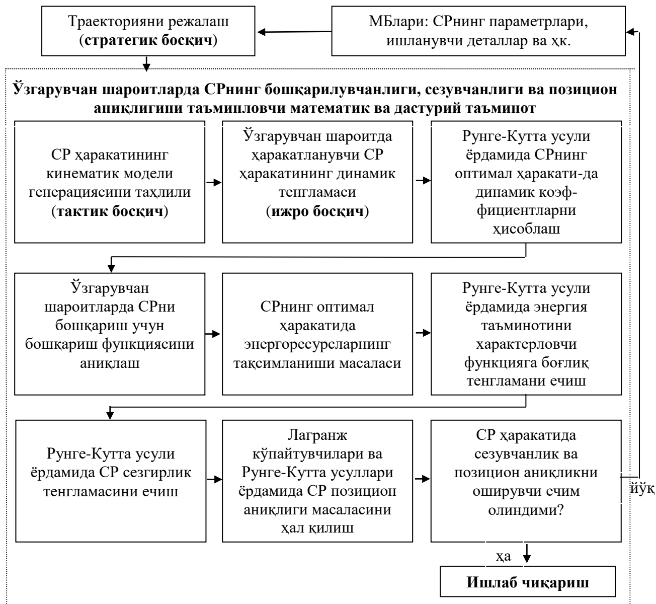
2-расм. Ўзгарувчан шароитларда СРнинг бошқарилувчанлиги, сезувчанлиги ва позицион аниқлигини таъминловчи математик ва дастурий таъминот схемаси
