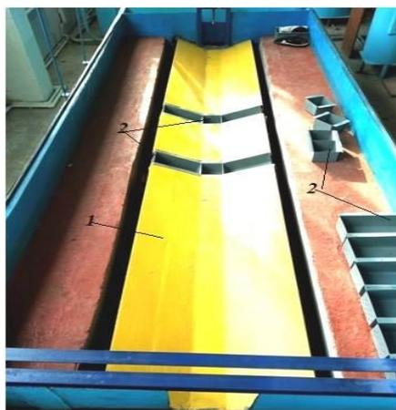
**2-расм. Трапецеидаль каналнинг модели:** 1 – ёғоч канал; 2 – металл қутилар
