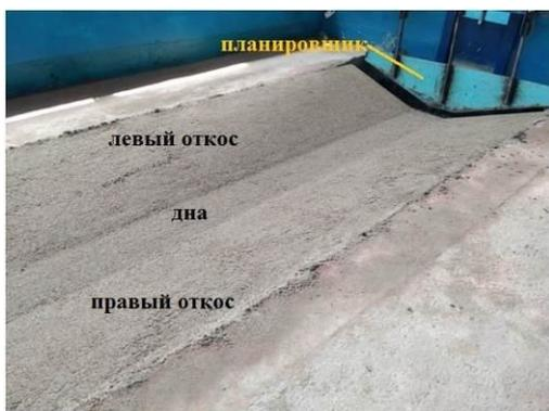
**Рис.4. Модель трапецидального канала из несвязного грунта**
