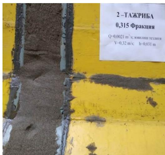
**Рис.3. Размыв несвязного грунта**
