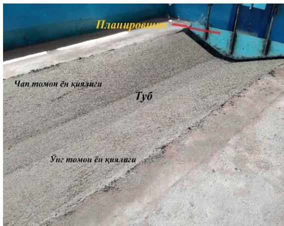
**4-расм. Боғланмаган грунтли трапецеидаль канал модели**
