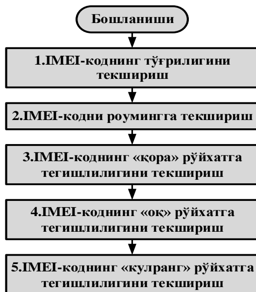
6-расм. IMEI-кодни идентификациялаш умумлашган чизиқли алгоритми
