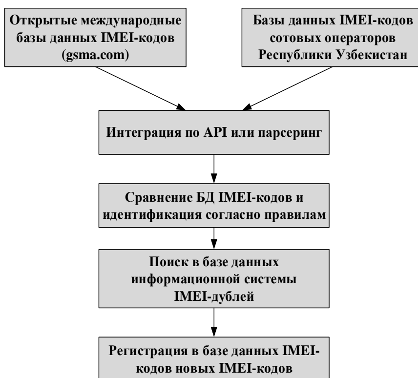
Рис.9. Алгоритм сравнения баз данных IMEI-кодов, идентификации и регистрации новых IMEI-кодов мобильных устройств
