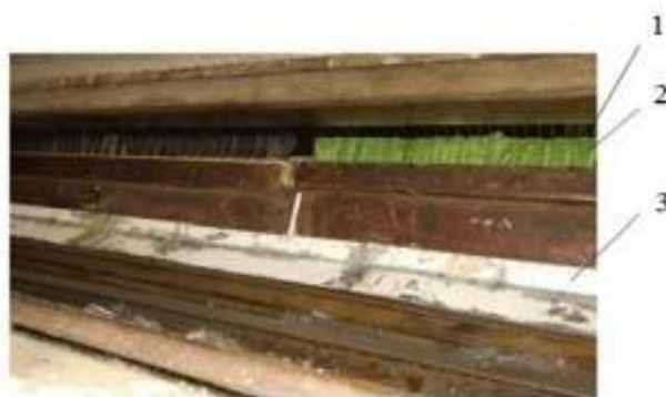
Рис.12. Внутренний вид двухбарабанного волокноочистителя с установленным направляющим устройством. 1- пыльный цилиндр, 2- притирочная щётка, 3-направляющее устройство
