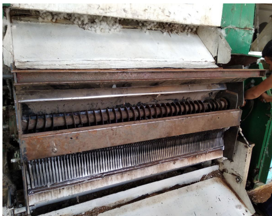
Рис. 10. Пильный джин с усовершенствованным типом рабочей камеры
