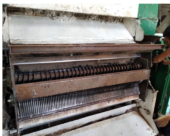
10-расм. Такмиллаштирилган ишчи камера билан жиҳозланган аррали жинлаш машинаси
