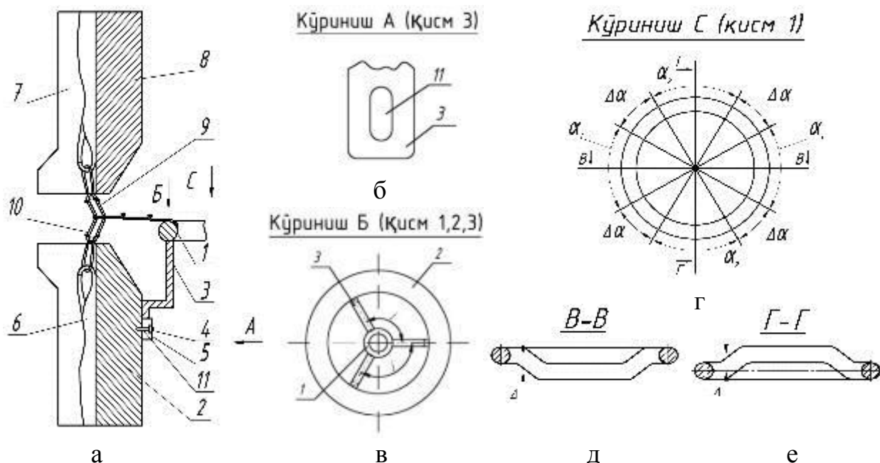
6-расм. Айлана икки игнадонли тўқув машиналарида трикотажд матосини тортишга мўлжалланган йўналтирувчи мослама (I-вариант)
