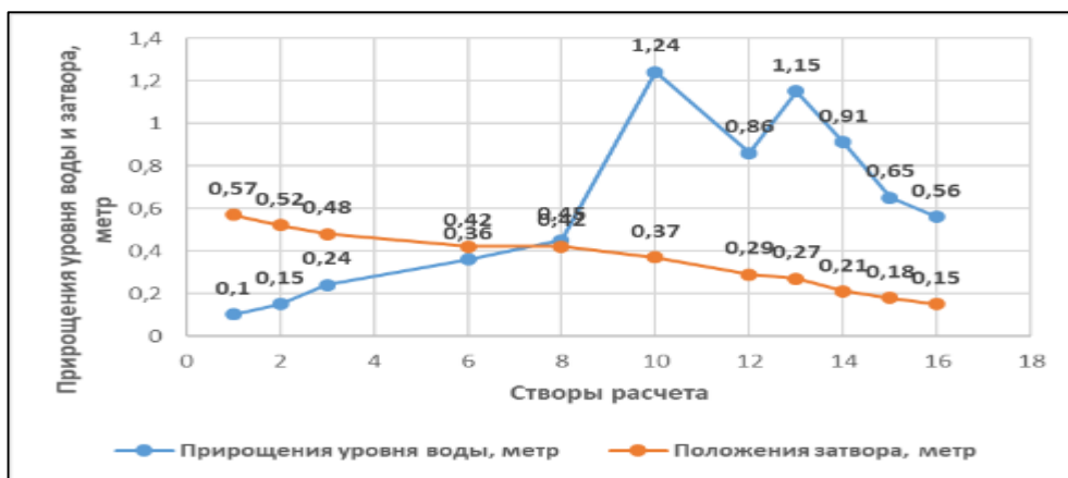
Рис 14. Регулирование уровня воды на II-участке канала
