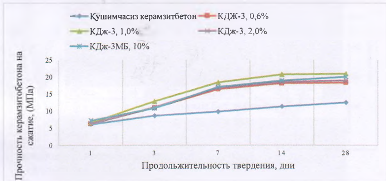
Рисунок 2. Влияние комплексных химических добавок КДж-3 и КДж-ЗМБ на прочность керамзитобетона на сжатие.
