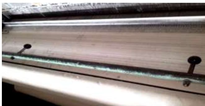
Рис. 3.2. Ткань, образованная в процессе управления учебным станком без частотного преобразователя
