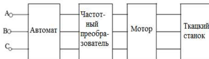
Рис. 3.3. Схема управления асинхронным мотором ткацкого станка с помощью частотного преобразователя
