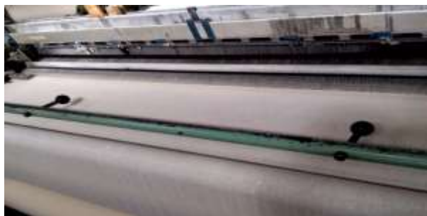
3.6- расм. Тўқув дастгоҳининг асинхрон моторини частота ўзгартгич орқали бошқариш жараёнидаги ҳосил бўлган мато
