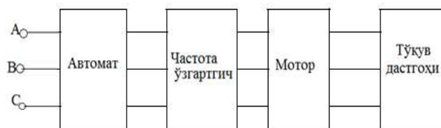
3.3-расм. Тўқув дастгоҳининг асинхрон моторини частота ўзгартгич ёрдамида бошқариш схемаси
