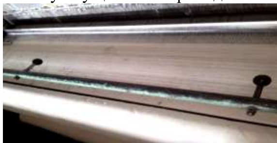
3.2-расм. Тўқув дастгоҳини частота ўзгартгичсиз бошқариш жараёнидаги ҳосил бўлган мато
