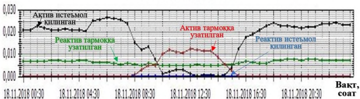
7-расм. ҚЭХИ да 18.11.2018 йилда ФЭСлар томонидан ишлаб чиқарилган ва истеъмол қилинган электр энергияси графиги
