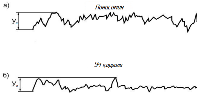
6-расм..Тишларнинг лаборатория моделлари учун кесии қаршилиги кучининг осциллограммаси.
