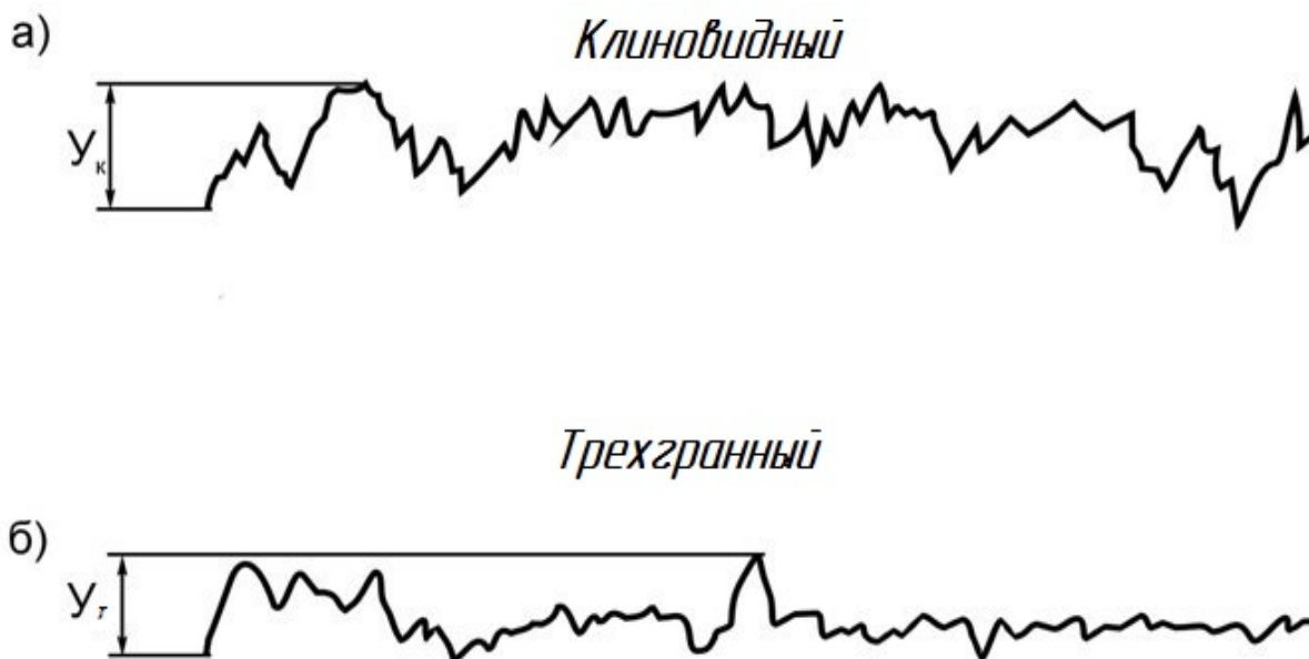
Рис. 6 Осциллограммы силы сопротивления резанию для лабораторных моделей зубьев.
