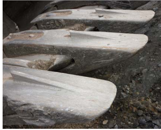
16-расм. Эскаватор ковшининг уч қиррали кўринишдаги тишининг ишлатиш синовларидан кейинги ейилиши ўлчами ва характери.
