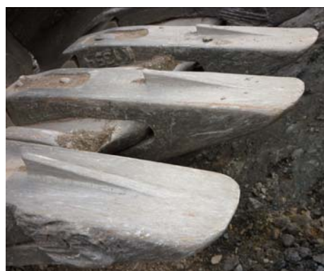
Рис. 16. Величина и характер износа трехгранного зуба ковша экскаватора после эксплуатационных испытаний.
