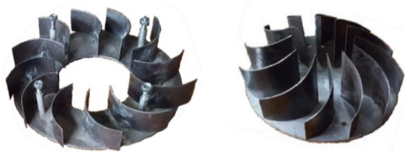
8-расм. Йўналтирувчи кураклар шакли: а – тўртбурчакли эгри ва б - трапеция шаклидаги кураклар
