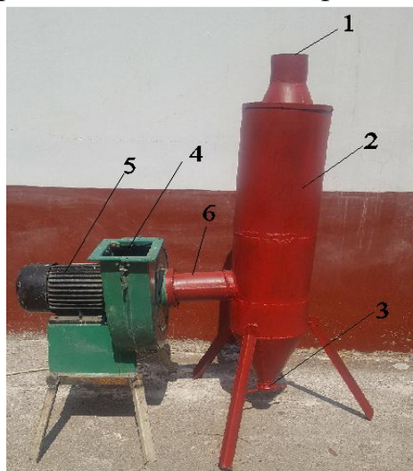
Рис. 7. Лабораторный сепаратор для получения тонкодисперсных порошков
